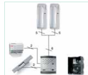
Kit per 1 pulsante doppio con sistema di chiamata 4+N senza apriporta.
