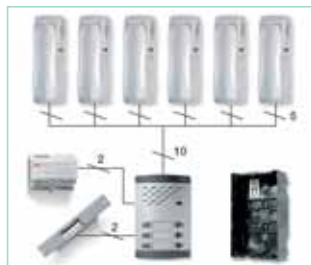
Kit per 4 pulsanti doppi con sistema di chiamata 4+N con apriporta.
