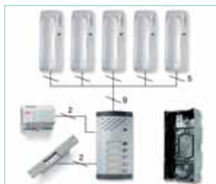
Kit per 5 pulsanti singoli con sistema di chiamata 4+N con apriporta.
