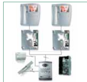
Kit per 3 pulsanti doppi con sistema di chiamata 4+N con apriporta.
