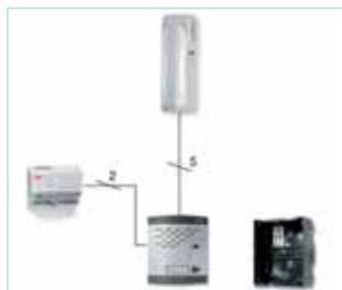
Kit per un pulsante singolo con sistema di chiamata 4+N senza apriporta.
