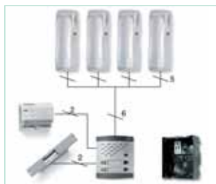
Kit per 2 pulsanti doppi con sistema di chiamata 4+N con apriporta.
